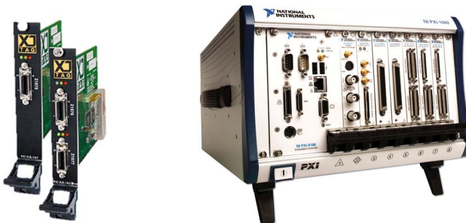
Schede PXI di XJTAG per il test Boundary Scan e cestello PXI di National Instruments equipaggiato con moduli hardware
