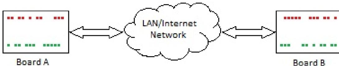
La figura precedente illustra il flusso della comunicazione: quando il servizio è attivo su entrambe le schede, la *Board A* invia lo stato dei propri ingressi che verranno replicati sulle uscite della *Board B*, ed allo stesso modo, lo stato degli ingressi della *Board B* verranno replicati sulle uscite della *Board A*.
