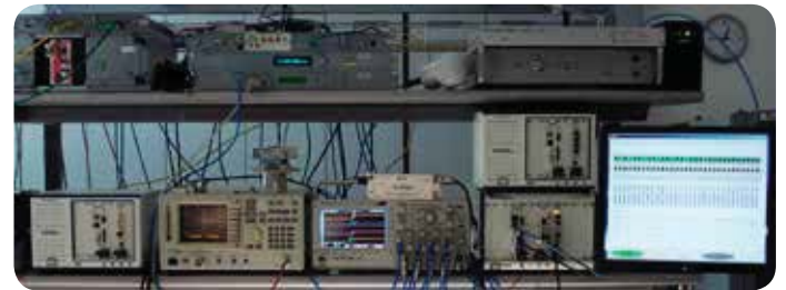
Figura 1: Banco di test del sistema: al centro vi è l'oscilloscopio con cui vengono confrontati i PPS generati da 4 differenti dispositivi (tra cui quello simulato dal PXI), a destra il cestello PXI, sopra altri sistemi di sincronizzazione e timing
