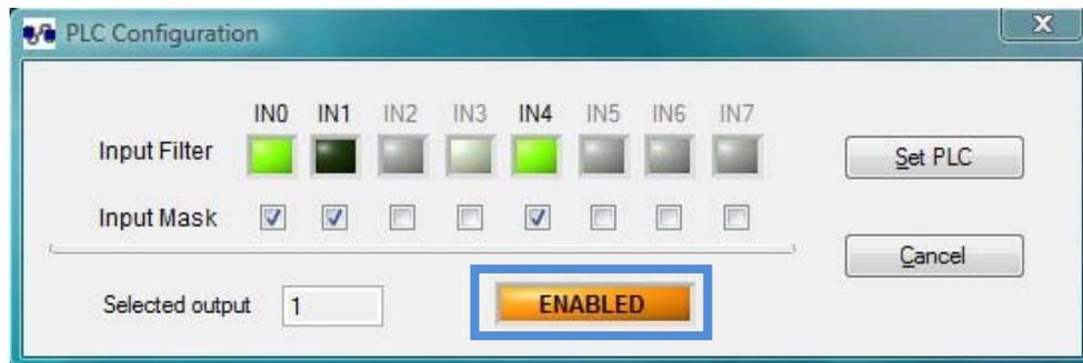
Figura 19: finestra di *pop-up* per la configurazione dei parametri di maschera e filtro PLC.
