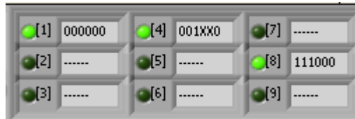
Figura 15: stato programmazione logica delle uscite, l'indicatore verde illuminato indica lo stato di uscita programmata.
