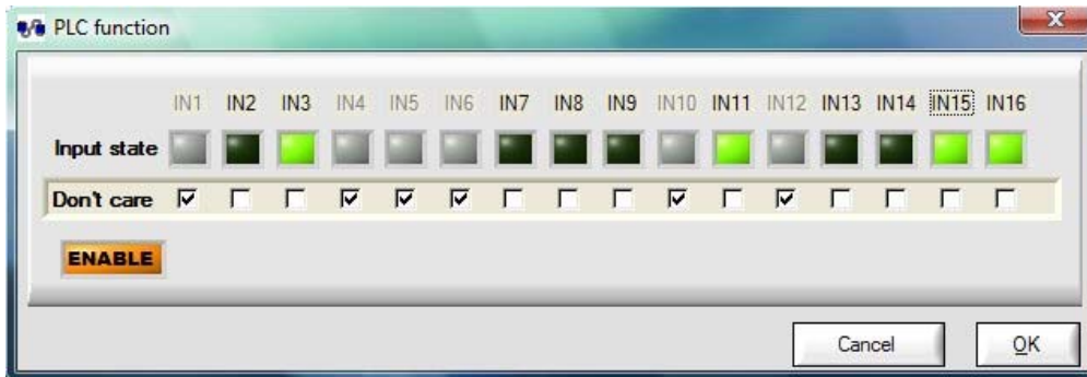
Figura 5b: pannello PLC.
