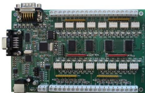
CAN-I/O è una scheda di gestione di sedici ingressi e sedici uscite optoisolati in grado di operare autonomamente su CAN bus e la sua configurazione può avvenire o attraverso USB (in questo caso la scheda è autoalimentata) oppure attraverso l'interfaccia RS232. Di semplice utilizzo e facilmente configurabile, anche grazie al software di cui è dotata, CAN-I/O è il sistema ideale per acquisire e pilotare segnali digitali sfruttando bus di campo già esistenti.
