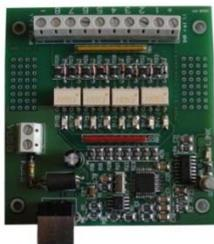
La scheda IN8 è un sistema di controllo autoalimentato da USB di ridotte dimensioni in grado di leggere lo stato di 8 ingressi isolati galvanicamente: su ciascun ingresso è quindi possibile applicare tensioni non riferite alla massa della scheda e di valore massimo pari a 36V.
