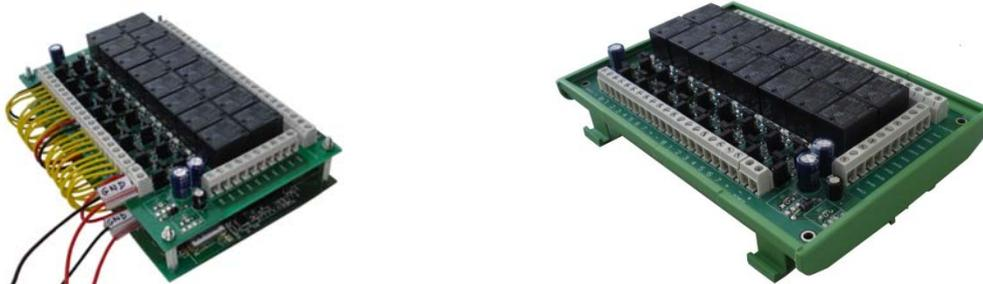
**Alimentazione:** esterna, a 5V<sub>DC</sub> o da +7V<sub>DC</sub> a +24V<sub>DC</sub>, a seconda del modello (RELÉ-IO-5-(SEL) o RELÉ-IO-24-(SEL))
