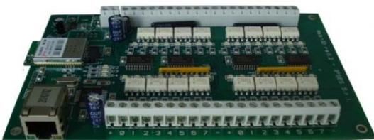
WEB-IO-WiFi è una scheda di gestione di sedici ingressi e sedici uscite optoisolati con interfaccia Ethernet e WiFi che implementa sia un server WEB, sia un server telnet, sia un server SNMP. Il server web permette di connettersi e controllare la scheda utilizzando qualsiasi browser di navigazione (per esempio Internet Explorer o Firefox), senza dover installare alcun software sul proprio PC.
