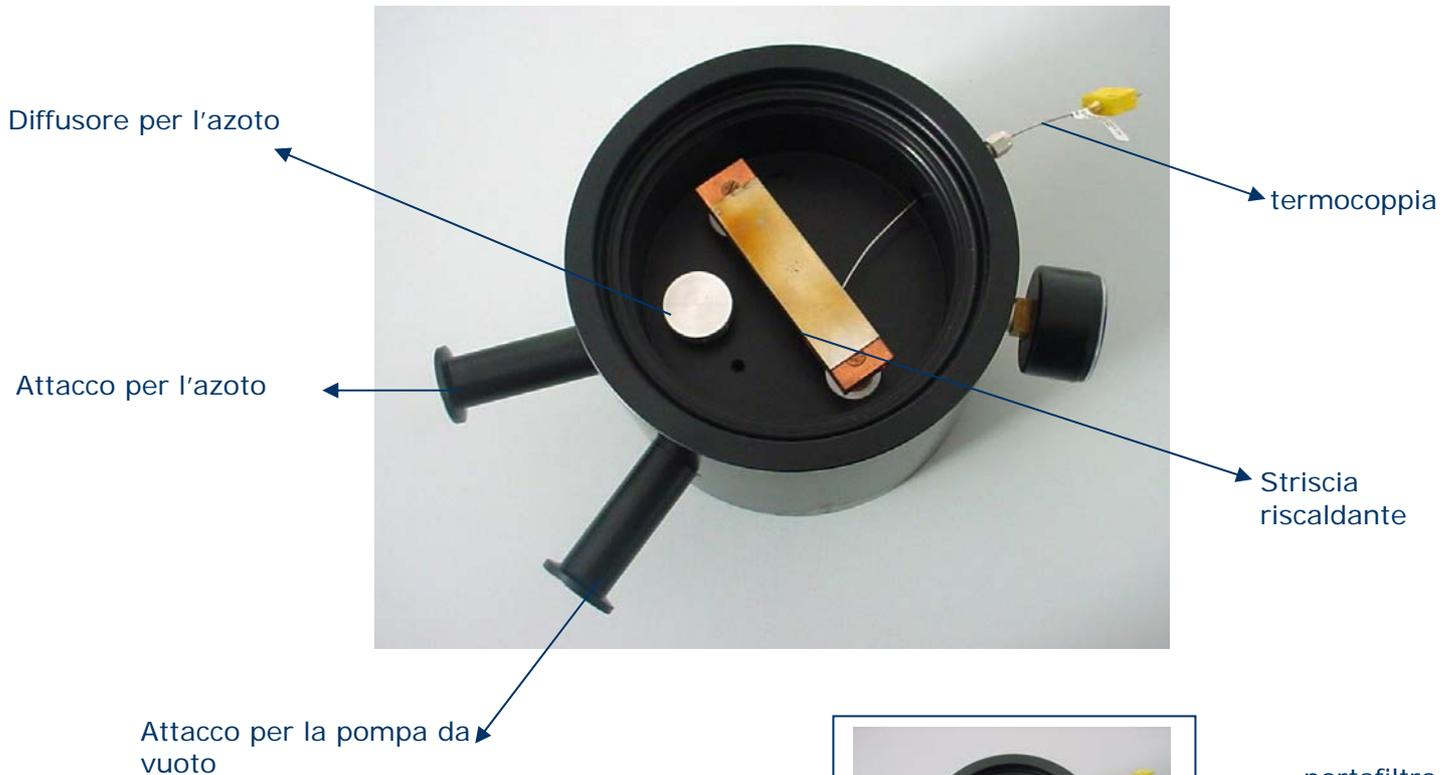
Il fornello è dotato di un apposito filtro e portafiltra da inserire al suo interno in caso di misure di campioni con elevata emissione fotonica
