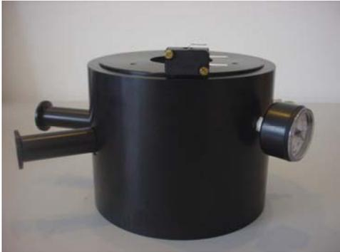
Il fornello a tenuta di vuoto è stato concepito e realizzato per riscaldare il campione da sottoporre ad analisi per termoluminescenza. Il riscaldamento avviene tramite un elemento riscaldante (striscia) in atmosfera inerte ottenuta grazie alla continua estrazione dell'aria dal suo interno mediante una pompa da vuoto e alla successiva immissione di azoto.
