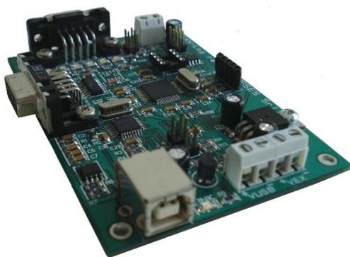
*CAN Sniffer* è una scheda che permette di interfacciarsi e monitorare il CAN bus attraverso USB (in questo caso la scheda è autoalimentata) oppure interfaccia RS232. Oltre al funzionamento come *sniffer*, interfacciata al PC, la scheda può anche inviare messaggi singoli o periodici completamente configurabili.
