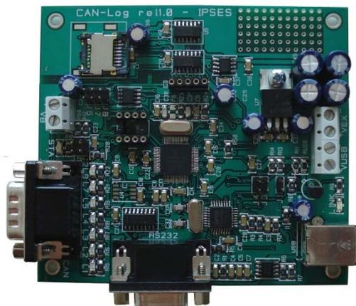
*CAN Logger* è una scheda in grado di filtrare e memorizzare tutti i frame CAN del bus su cui è connesso senza essere contemporaneamente collegato ad un PC. In ogni caso può comunque essere interfacciato direttamente al PC tramite l'interfaccia USB o l'interfaccia seriale RS232 di cui è dotata.
