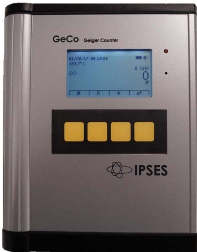
Tramite un connettore BNC è possibile connettere diverse sonde (Geiger Müller, proporzionali, scintillatori) selezionando la tensione di lavoro in funzione del tipo di sonda da interfacciare.
