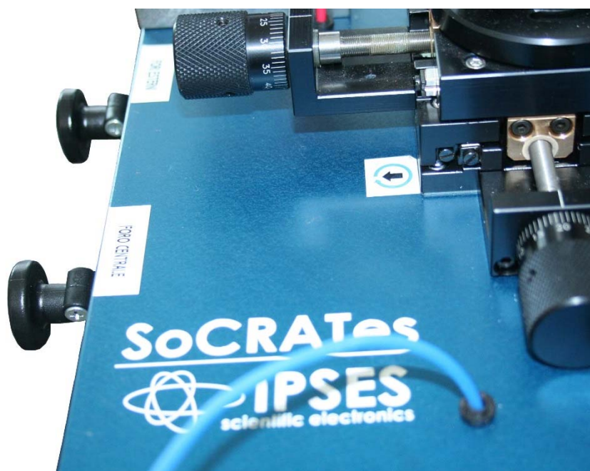
Figura 8 – Pulsanti di azionamento dell'aspirazione
