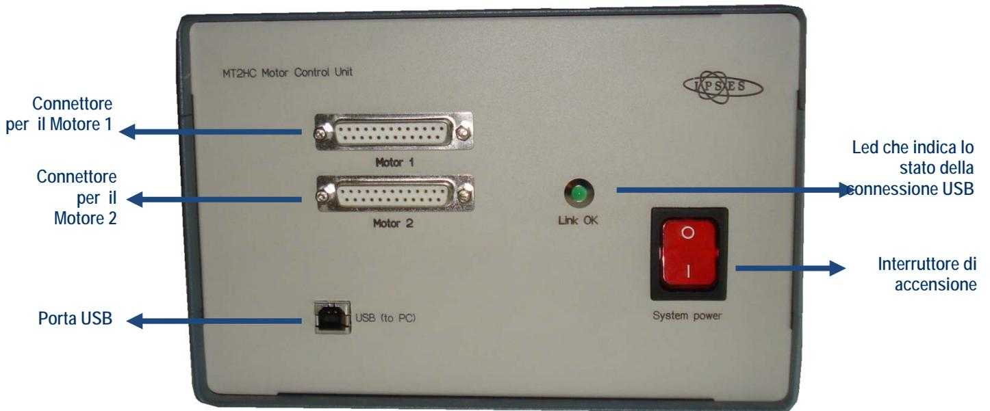
Figura 2a: MT2HC-BOX – Fronte- Posizione dei connettori e della porta USB
