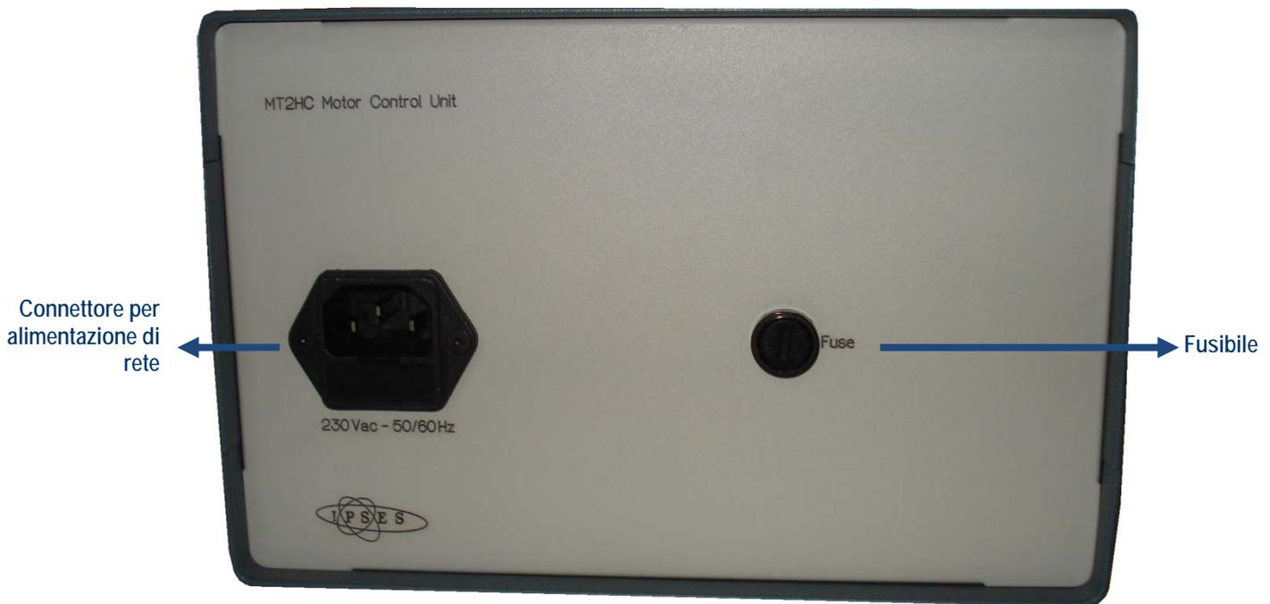
Figura 2b: MT2HC-BOX – Retro- Posizione del connettore per l'alimentazione di rete e del fusibile a protezione dell'uscita a 15V<sub>DC</sub> dei connettori dei motori posti sul fronte
