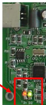
Figura 2: LED di scambio dati e avvenuta connessione.
