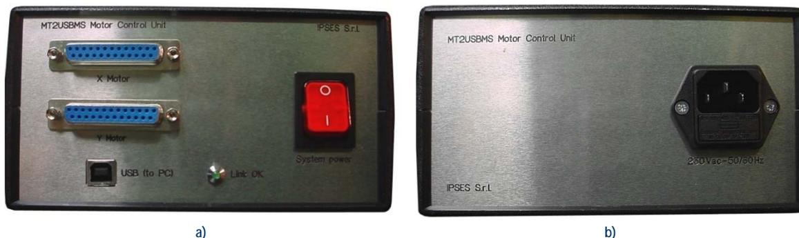
Figura 12: a) fronte e b) retro del box per MT2USBMS; analogo è il box per MT2USB.
