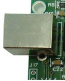
**J1 (USB):** connettore di tipo B, con cui interfacciarsi verso un PC.
