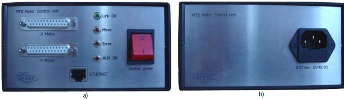
Figura 18: a) fronte e b) retro del box per MT2ETHMS; analogo è il box per MT2ETH.
