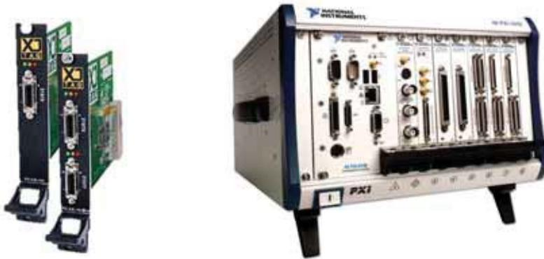
*Schede PXI di XJTAG per il test Boundary Scan e cestello PXI
