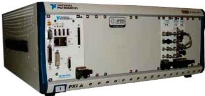
Figura 2: Il cestello PXI utilizzato per il progetto, popolato con i moduli embedded PC, modulatore RF e upconverter
