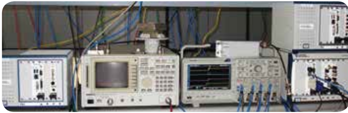
Figura 2: Primo setup di un banco di test utilizzato per effettuare le prime prove di validazione del sistema. A destra in basso si può notare il sistema NI PXI attivo.
