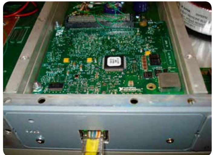
Figura 1: La scheda Single-Board RIO (vista bottom) all'interno del sistema con il connettore Ethernet e i LED direttamente riportati sul fronte
