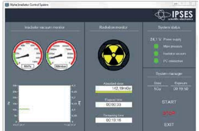
Figura 3: Software: L'interfaccia operatore sviluppata in LabVIEW con le finestre per il settaggio parametri, il grafico e gli indicatori per il monitoraggio valori e lo status di processo
