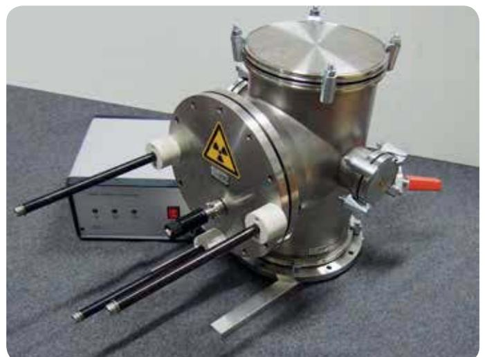
Figura 1: Irraggiatore: L'irraggiatore alpha con il controller di interfacciamento verso il PC
