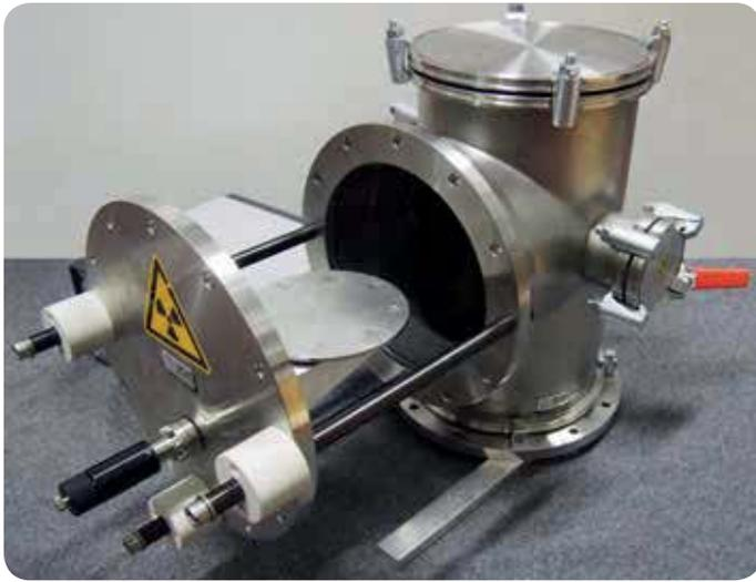
Figura 2: Irraggiatore aperto: L'irraggiatore alpha aperto con il piattello portacampioni rotante
