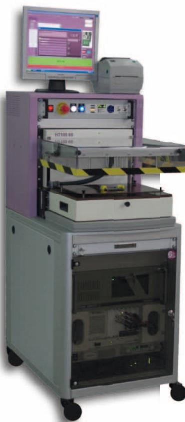
**Fig. 1 - Piattaforma di test 6TL-22, ATE modulare con tutti i componenti hardware e software necessari a eseguire correttamente il test**
