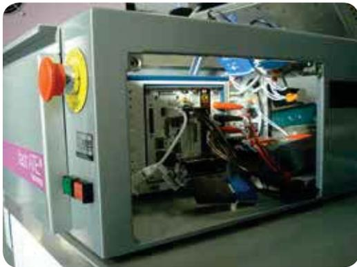
Figura 2: Chassis PXIe-1071, popolato con il controller PXIe-8840, la scheda NI DAQ X Series e la NI PXI-4065 per la gestione del test funzionale e la scheda XJlink2 di XJTAG.
