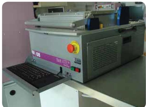
Figura 1: Piattaforma di test modulare 6TL-08 con fixture standard a cassetto integrata.
