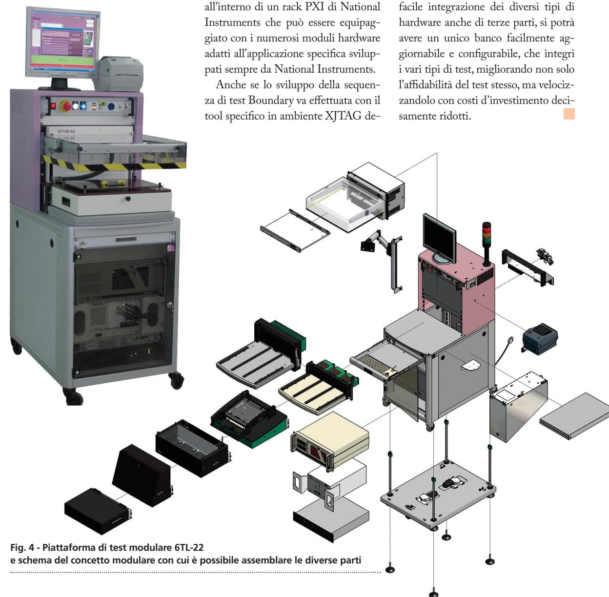
Fig. 4 - Piattaforma di test modulare 6TL-22 e schema del concetto modulare con cui è possibile assemblare le diverse parti
