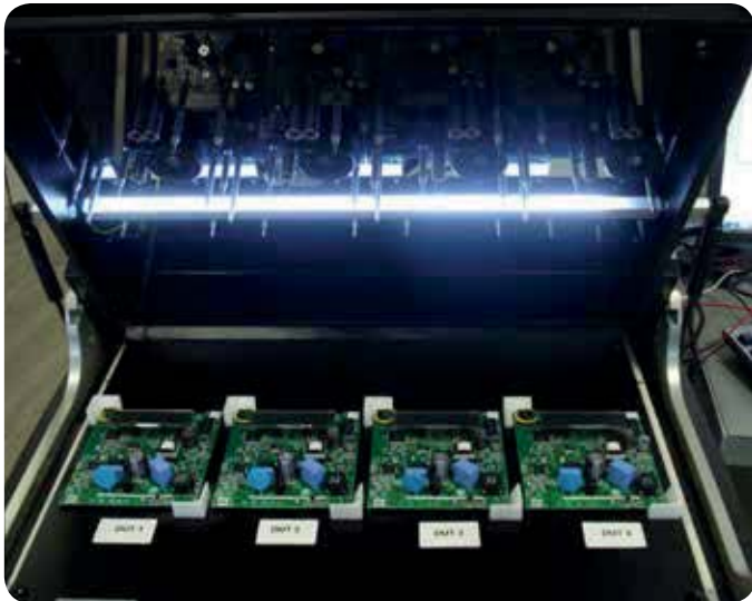
Figura 2: Fixture: la fixture del banco per il test funzionale e di visione di 4 DUT in parallelo
