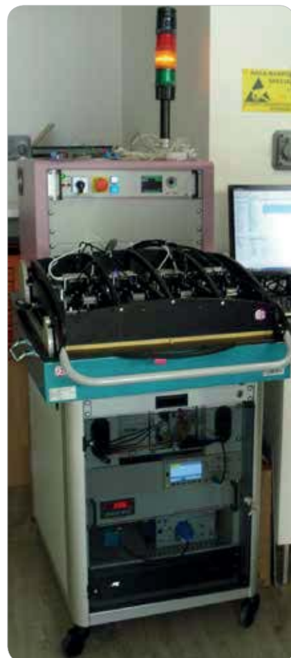
Figura 1: Banco di Test: la piattaforma di test realizzata con il PXI integrato
