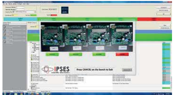
Figura 3: Sequenza di test: la sequenza di test consente un'immediata identificazione degli esiti positivi e negativi dei singoli step da parte dell'operatore
