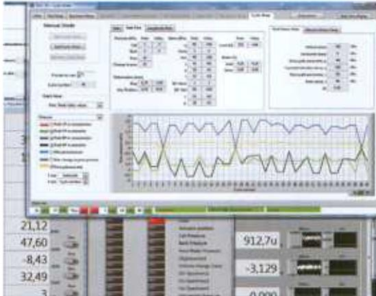
Figura 1: Pannello di controllo dell'applicazione durante un test dinamico ciclico; sullo sfondo altri pannelli (floating) di visualizzazione dati real-time
