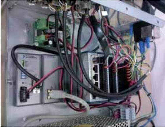
Figura 2: Dettaglio del compactRIO, inscatolato e connesso all'intero sistema
