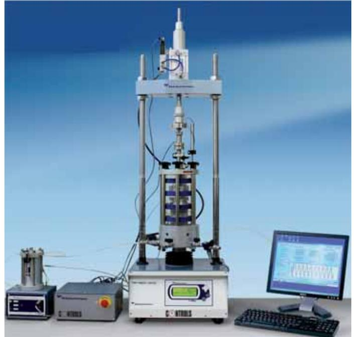
Figura 3: Sistema completo (da sinistra a destra: misuratore variazioni volumetriche, compactRIO inscatolato, sistema di test e, infine, personal computer)
