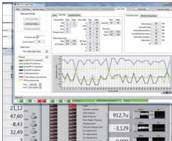
Figura 1: Pannello di controllo dell'applicazione durante un test dinamico ciclico; sullo sfondo altri pannelli (floating) di visualizzazione dati real-time
