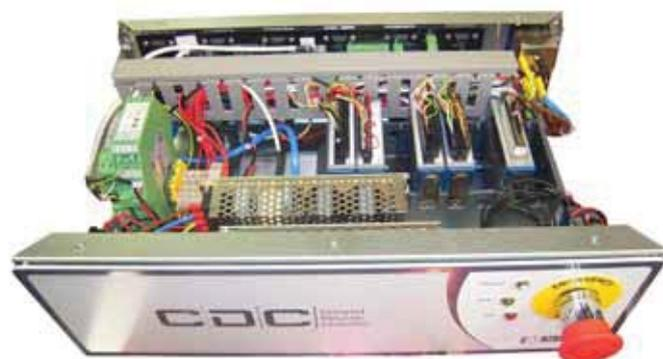
Figura 2: CompactRIO (con relativi moduli) inscatolato nell'apposito rack, con i LED e il tasto di emergenza sul fronte e i connettori di I/O sul retro
