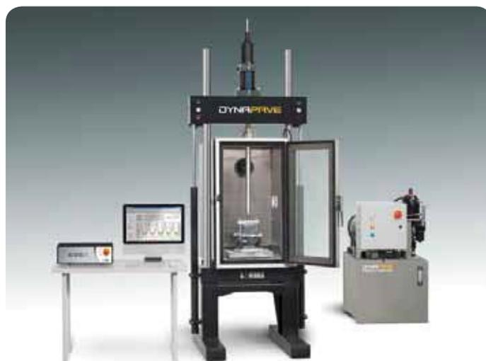
Figura 3: Il sistema completo (da sinistra a destra: il rack di controllo contenente il compactRIO, il PC, il sistema di test meccanico e il relativo sistema di gestione dell'idraulica)
